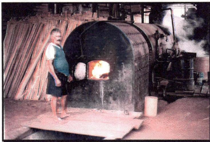
**Foto 39: Aspecto da caldeira para produção de calor, utilizando-se os “Roletes” das laminadoras.**
