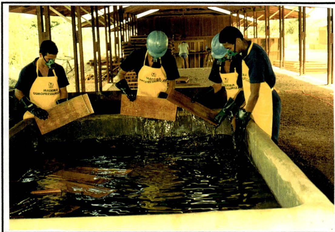
**Foto 43:** Tratamento de peças dos subprodutos das laminadoras em tanque preservativo, que consiste em imergir em uma solução preservativa com ação fungicida e inseticida à temperatura ambiente, durante um intervalo de tempo.
