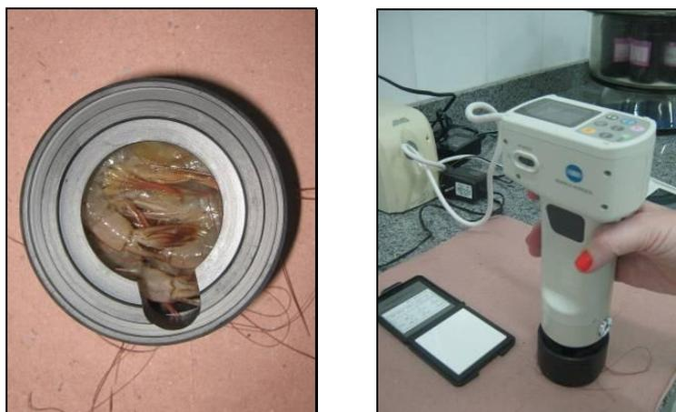
**Figura 5.** Amostra em cápsula preta, colorímetro CR-400 e placa de calibração (branco).
