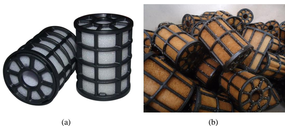
Figura 4.7 – Fotos do material suporte Biobob®: (a) sem biomassa e (b) com biomassa aderida.
