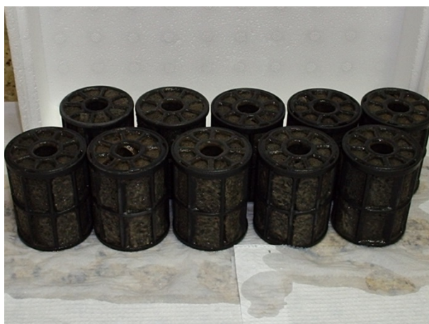
Figura 5.19 – Fotos das amostras de Biobob® coletadas do leito fixo do HAnR.
