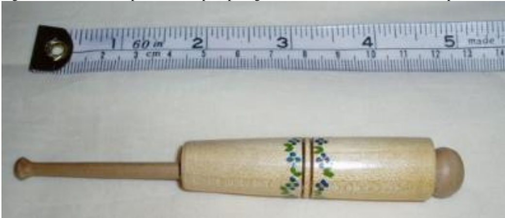
Figura 34 – Bilro com capa removível para proteger o fio enrolado na haste. Com a capa.
