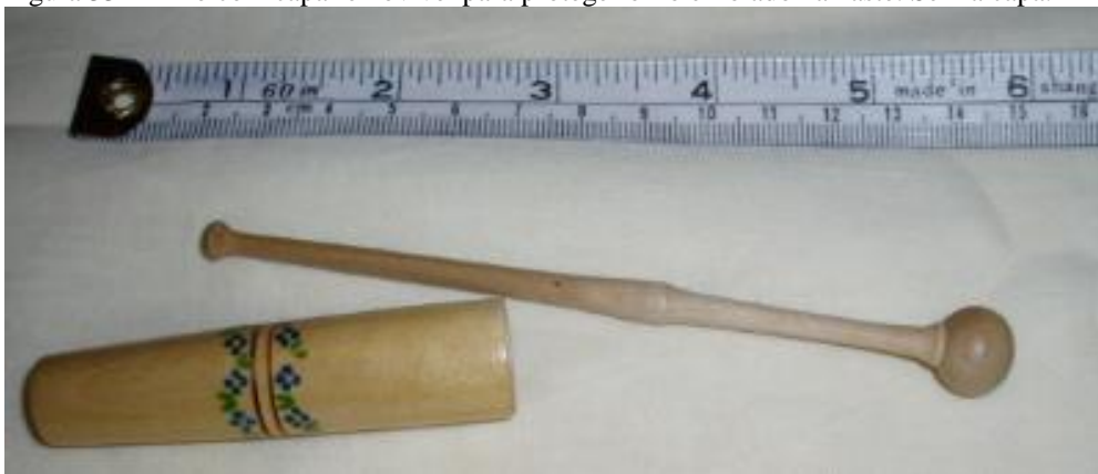
Figura 33 – Bilro com capa removível para proteger o fio enrolado na haste. Sem a capa.
