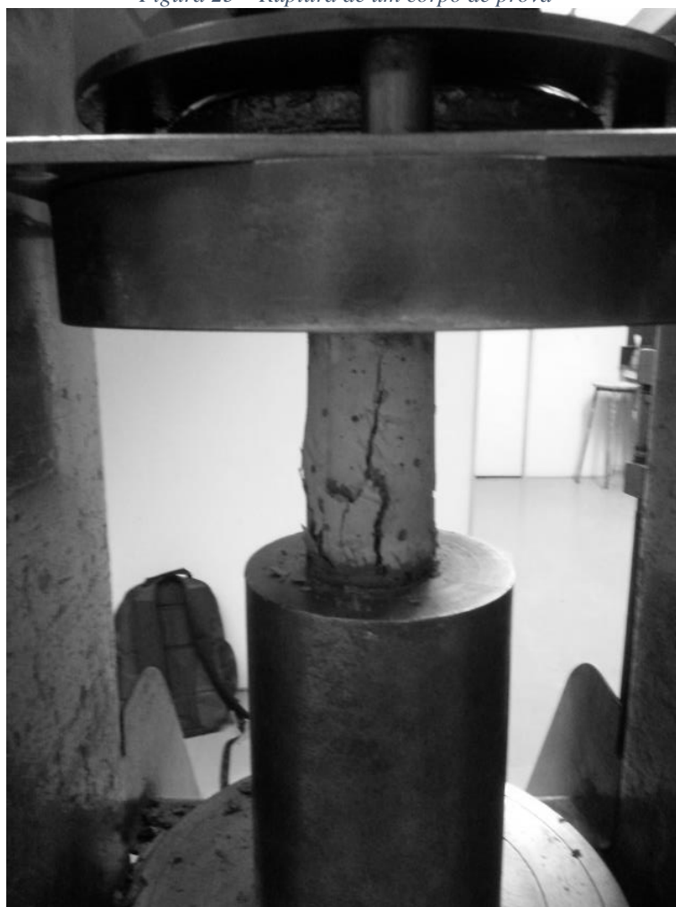
Figura 25 – Ruptura de um corpo de prova
