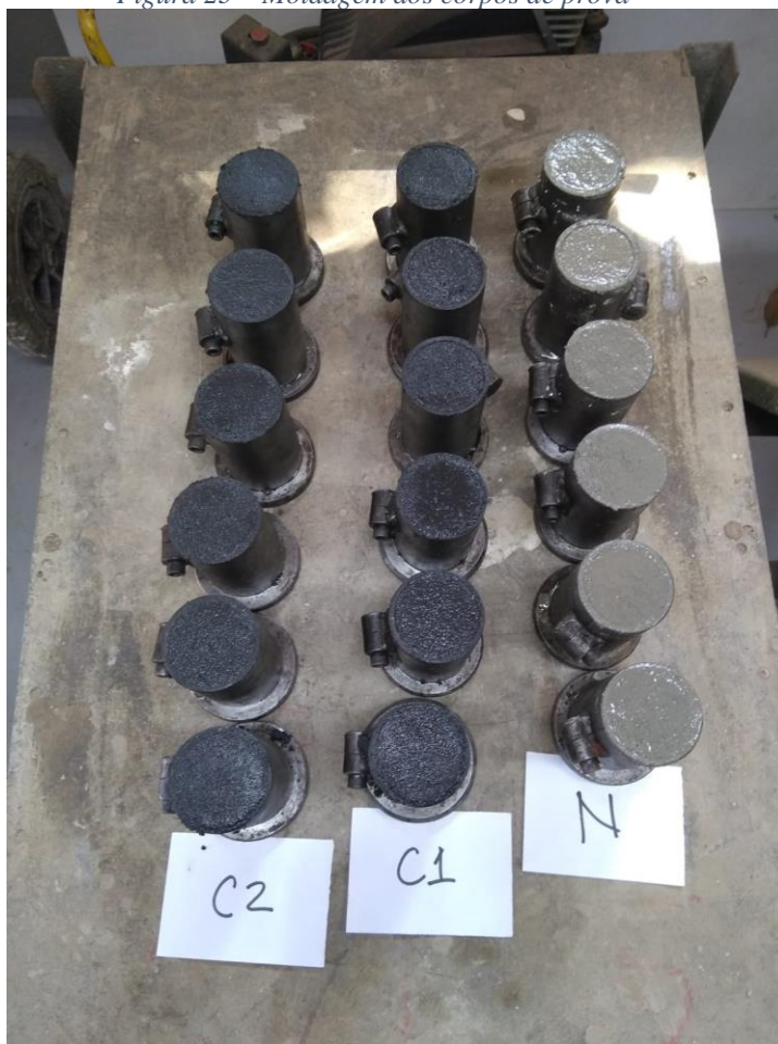
Figura 23 – Moldagem dos corpos de prova
