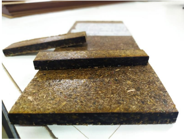
Figura 96.4.6.4.3 – detalhe do corte a laser na placa
