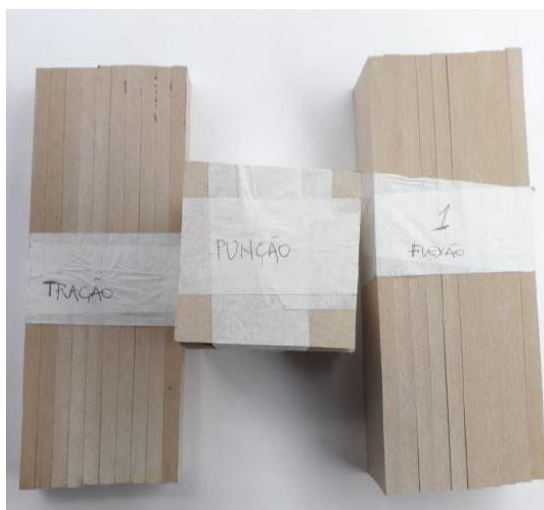
Figura 86.4.3.1.1 – identificação e organização das amostras de mdf para ensaios
