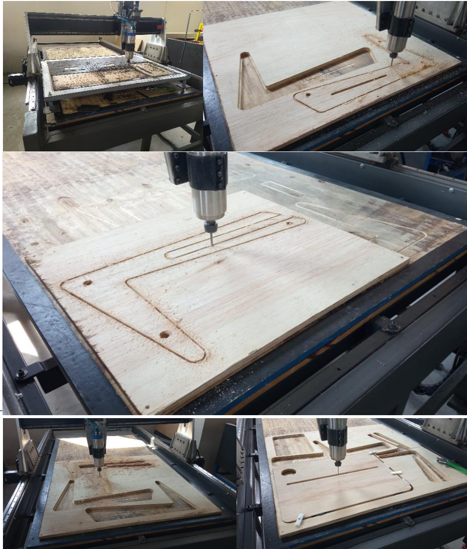
Figura 104.4.7.8 – realização corte da chapa em máquina CNC
