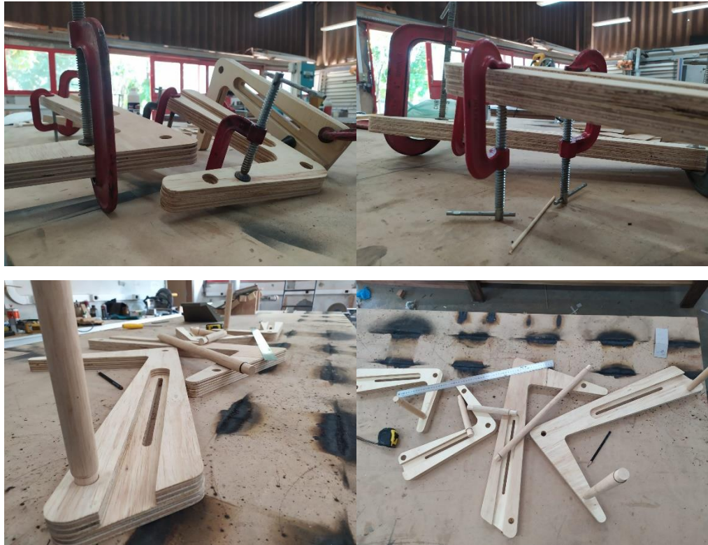
Figura 105.4.7.9 – colagem dos perfis e processo de montagem
