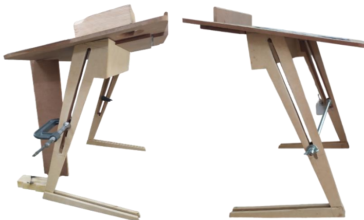
Figura 69.3.3.2.3.2 – montagem da mesa e verificação do sistema de regulagem de altura
