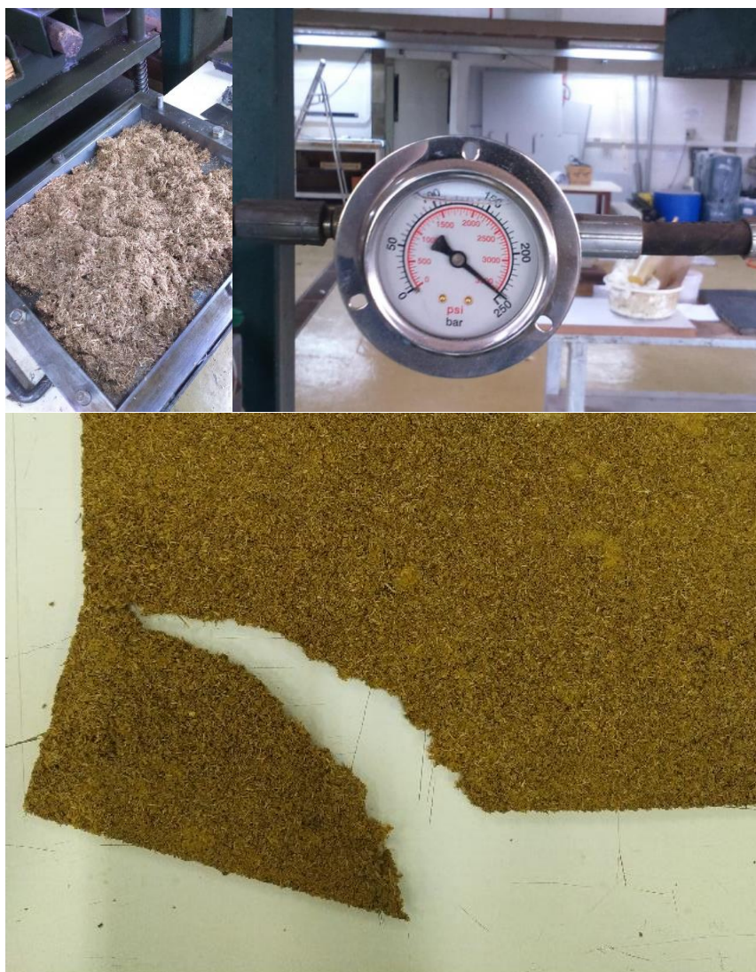
Figura 51.3.2.1.5 – material no molde e pesagem na prensa térmica
