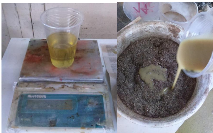
Figura 50.3.2.1.4 – pesagem da resina e mistura com material
