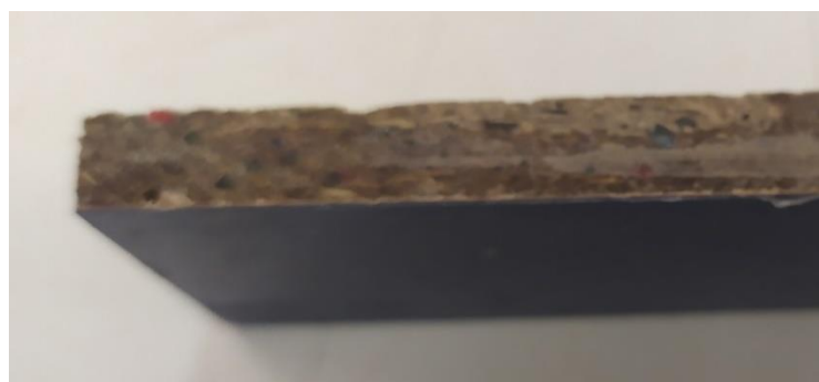
Figura 90.4.6.2.3 – acabamento da placa após 24 horas com utilização de resina de mamona
