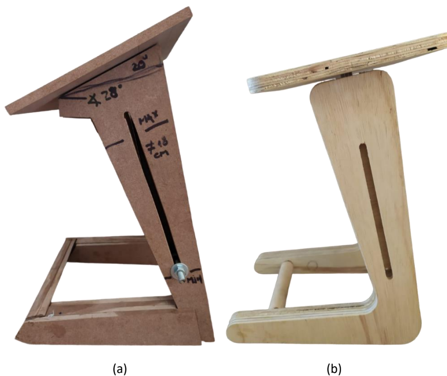
Figura 109.4.8.2 – comparação dos ângulos de assento dos mock ups: (a) 28° e (b) 13°
