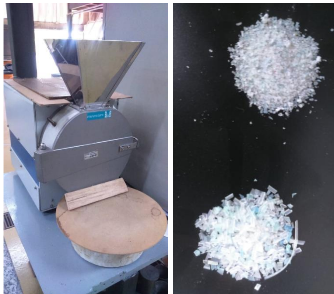
Figura 48.3.2.1.2 - Equipamento de moagem e a relação do material in natura e após a moagem
