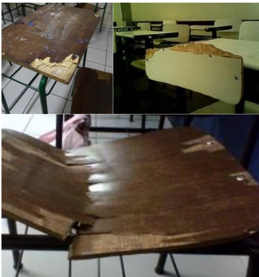
Figura 10.1.1.10 - Topo da cadeira sem parte do revestimento e consequente exposição ao perigo pelo aluno
