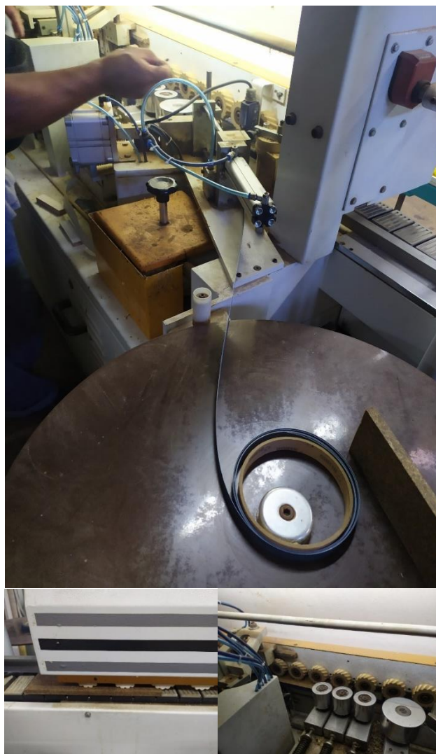
Figura 92.4.6.3.1 – fita de borda utilizada no processo de colagem
