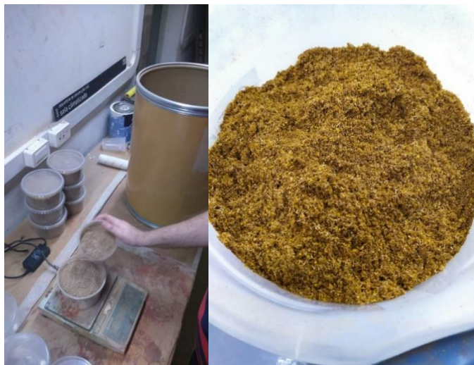
Figura 49.3.2.1.3 – pesagem do material em balança de precisão
