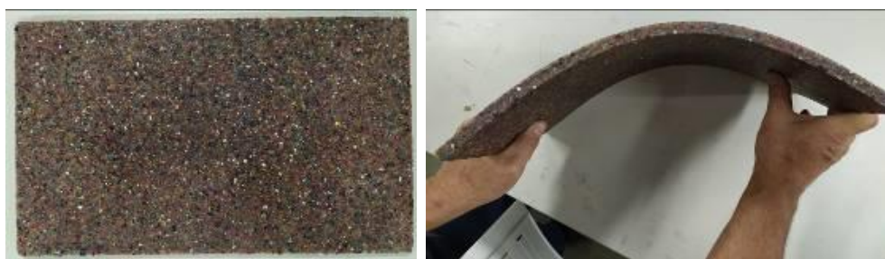
Figura 47.3.2.1.1 - Placa poliuretana termofixa e sua resistência
