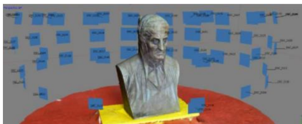
Figura 38 – Modelo Mesh texturizado do Busto criado no software Agisoft Metashape
