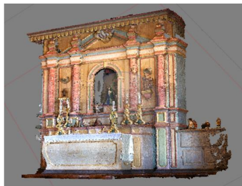
Figuras 29 e 30 – Modelo de nuvem de pontos com menos informações e Dense Cloud extraídos com a fotogrametria da Capela
