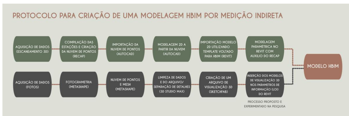
Figura 80 – Protocolo apresentando o processo para criação de uma modelagem HBIM por medição indireta e utilização da hipótese proposta na pesquisa
