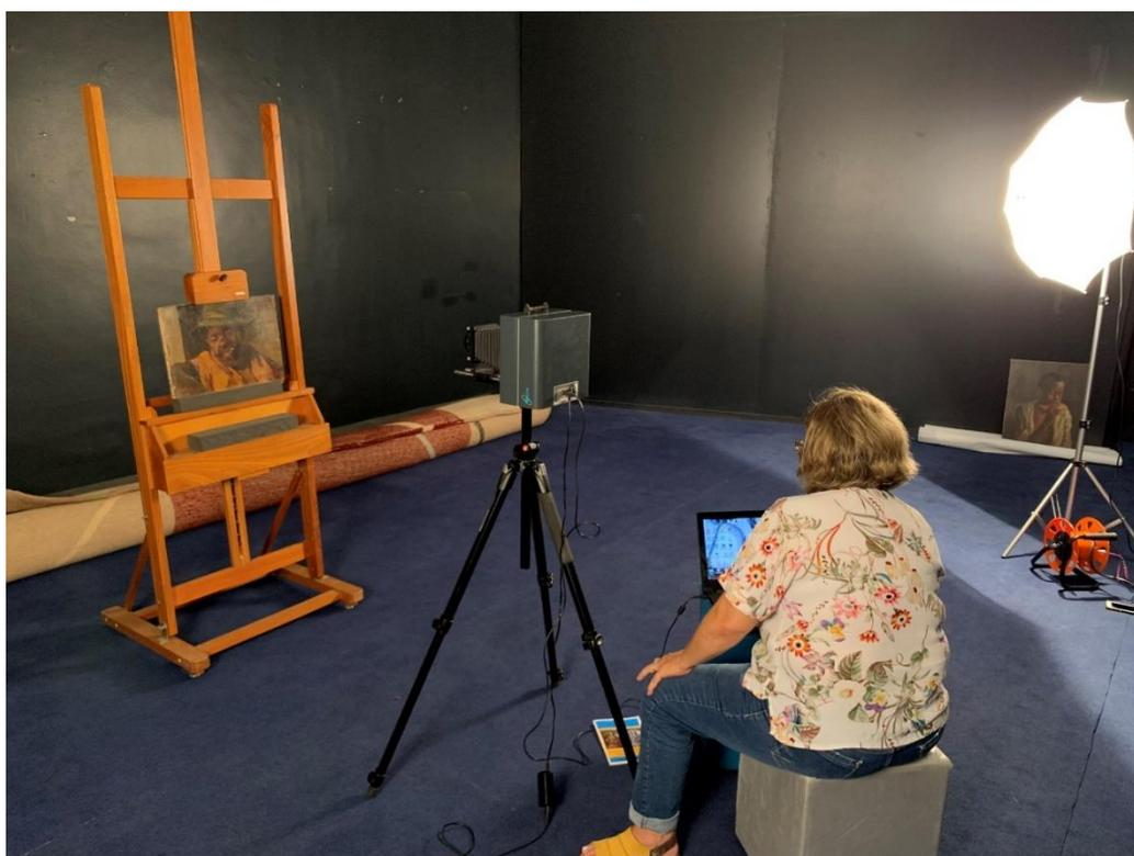
Figura 107 – Fotografia da montagem do processo de reflectografia de infravermelho da obra intitulada “Lúcio” assinada por Arthur Timótheo da Costa, acervo Museu Afro Brasil. Fonte: Autor, 2019
