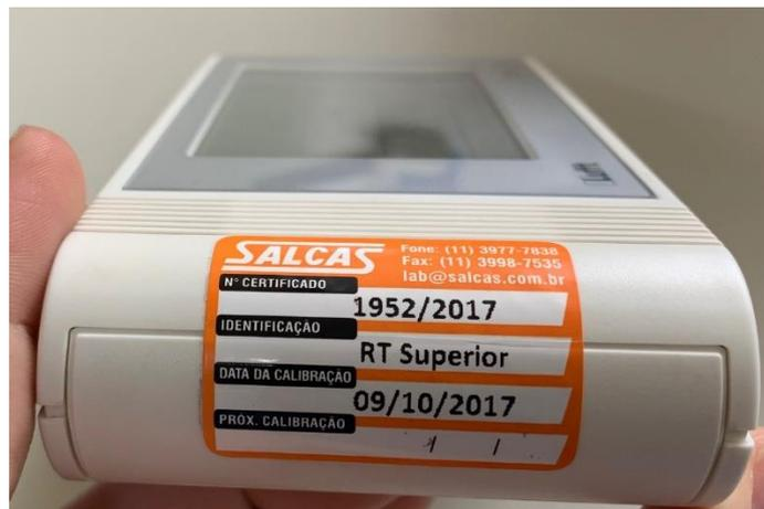
Figura 56 – Fotografia do datalogger OPUS 20 do Museu Afro Brasil com a última data de calibragem realizada no dia 09/10/2017. Fonte: autor, 2019
