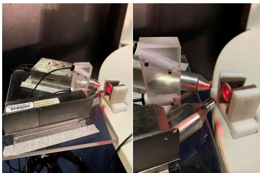
Figura 113 – Fotografias da utilização do Chumbo para a calibragem das medidas da Espectroscopia de Fluorescência de raios X por Dispersão de Energia (ED-XRF).
