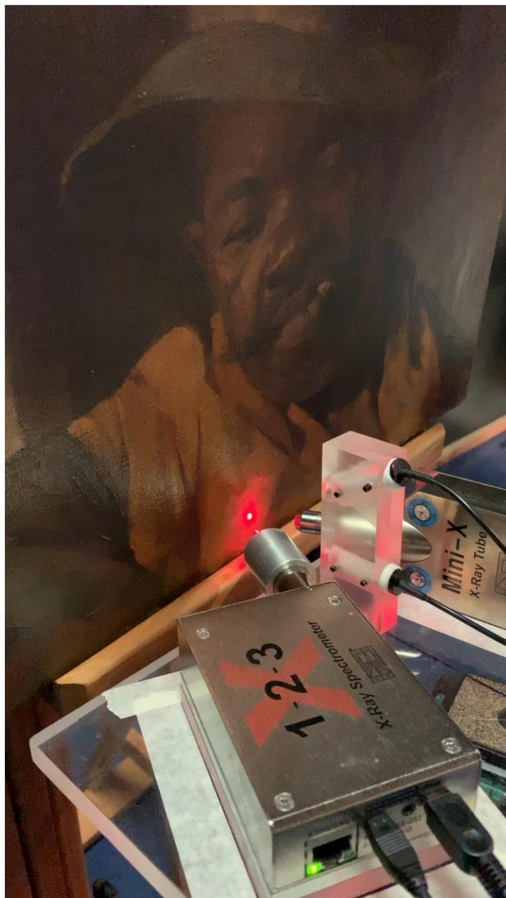
Figura 116 – Fotografia do detalhe do ponto P1 medido por Espectroscopia de Fluorescência de raios X por Dispersão de Energia da obra intitulada “Lúcio” assinada por Arthur Timótheo da Costa, acervo Museu Afro Brasil. Fonte: Autor, 2019
