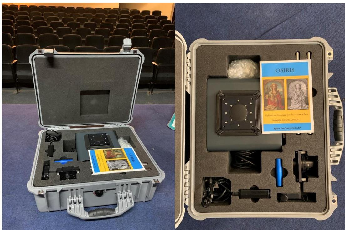
Figura 103 – Fotografias da câmara de reflectância de IR – Osiris, desmontada dentro da mala. Fonte: Autor, 2019
