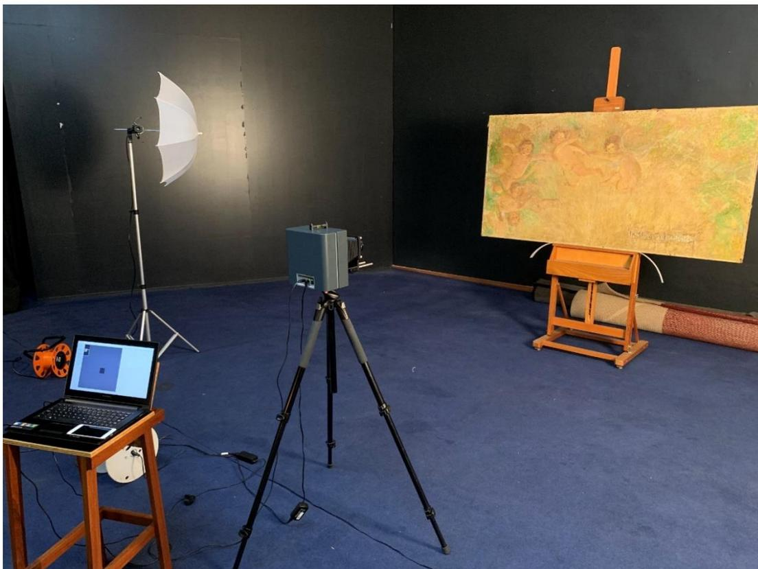
Figura 104 – Fotografia da montagem do processo de reflectografia de infravermelho da obra intitulada “Anjos”, assinada por Irmãos Timótheo, acervo Museu Afro Brasil.
