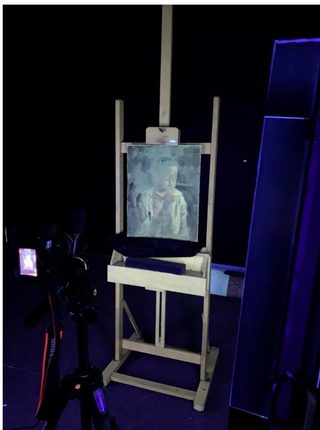
Figura 100 – Fotografia da montagem para a realização da fotografia de fluorescência visível com radiação ultravioleta (UV) da obra “sem título” assinada por João Timótheo da Costa, acervo Museu Afro Brasil. Fonte: autor, 2019
