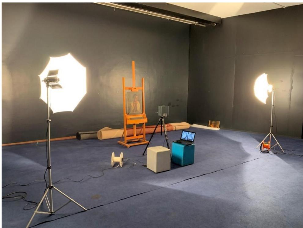
Figura 111 – Fotografia da montagem do processo de reflectografia de infravermelho da obra “sem título” assinada por João Timótheo da Costa, acervo Museu Afro Brasil.
