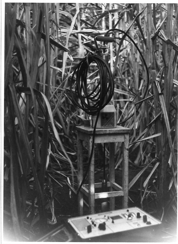
FIG. 9 - Determinação da umidade do solo com a sonda de neutrons no período final do ciclo da cultura.
