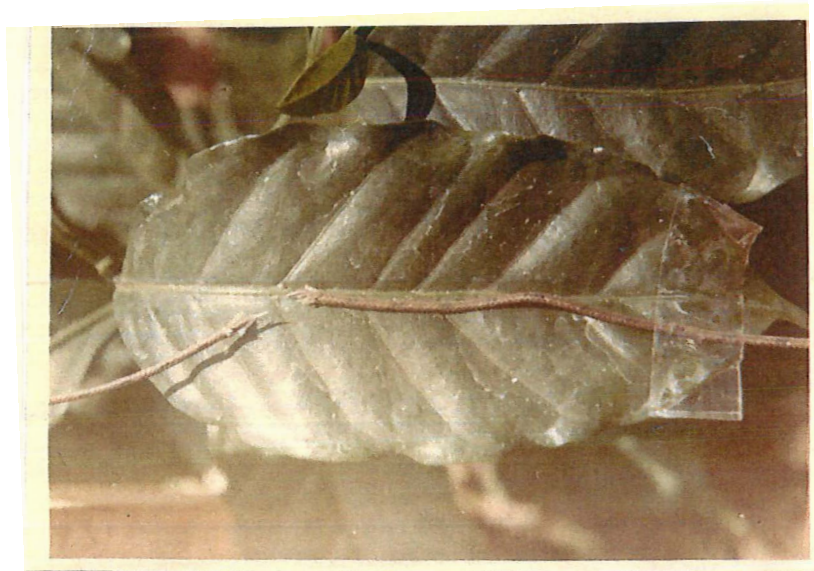
FIGURA 6 - Fotografia mostrando um par termoelétrico introduzido no mesofilo foliar através de uma domácia. Ao lado , outro par, no qual se pode vêr o tamanho da junção.
