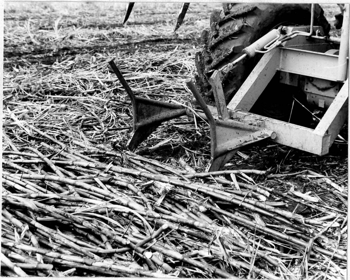
Figura nº 1. Detalhe do rastelo da carregadora mecânica. Canas dispostas em leiras contínuas. Usina São João, 1972.
