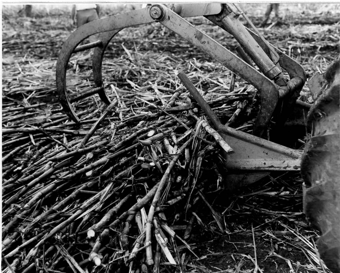
, Figura nº 2. Detalhe da garra em aço conjunta com o rastelo. Canas dispostas em leiras contínuas. Carregamento efetuado na Usina São João, 1972.
