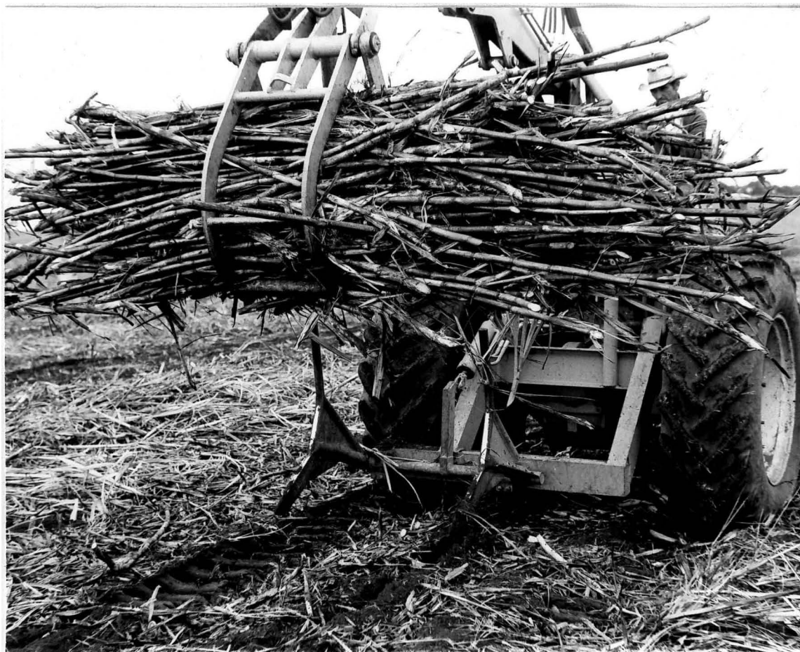
·Figura nº 4. Carregamento de canas em montes, visto de frente, mostrando o rastelo e a garra. Usi na São João, 1972.
