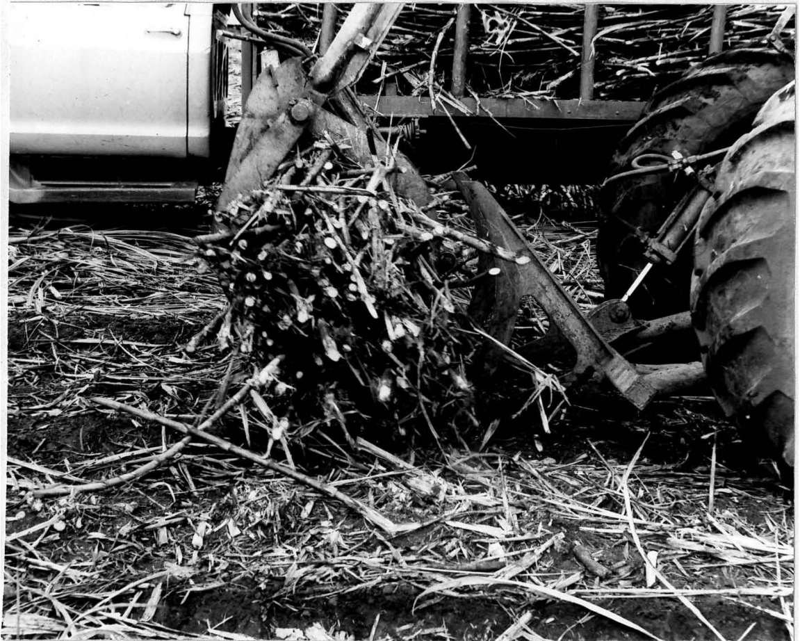
Figura nº 3. Detalhe da ação conjunta da garra e do rastelo em carregamento mecânico. Canas dispostas em montes. Usina São João, 1972.
