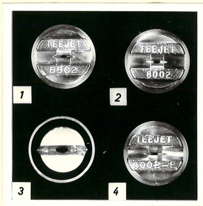
Figura 2. Vista superior das pontas dos bicos B 1 (1), B 2 (2), B 3 (3) e B 4 (4) utilizados nos ensaios preliminares.
