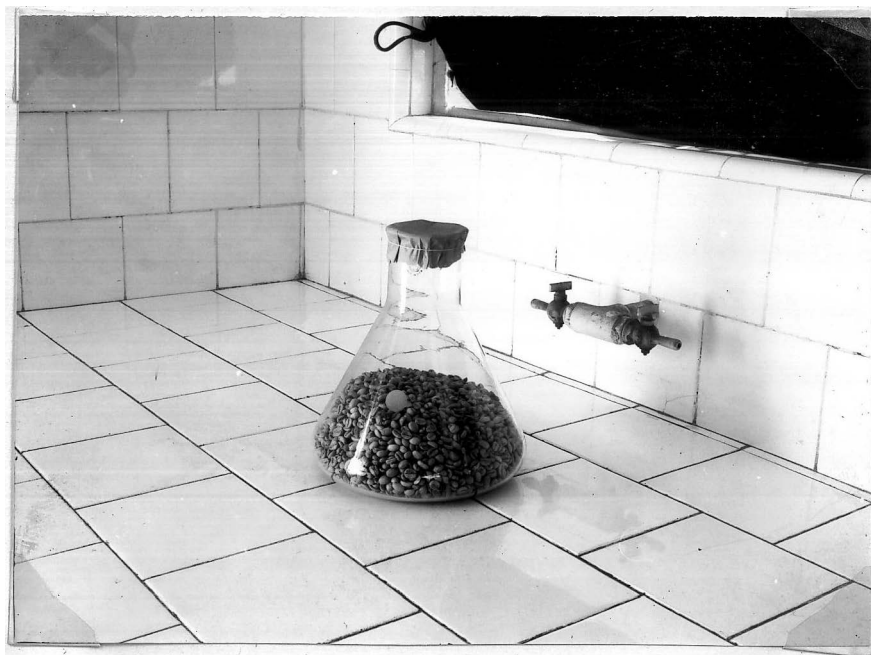
Fig.5 - Frasco tipo Fernbach usado na mistura de inseticidas aos grãos de café.
