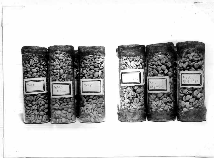
Fig.3 - Tubos de vidro usados nos ensaios biológicos com inseticidas e nos ensaios de fumigação.
