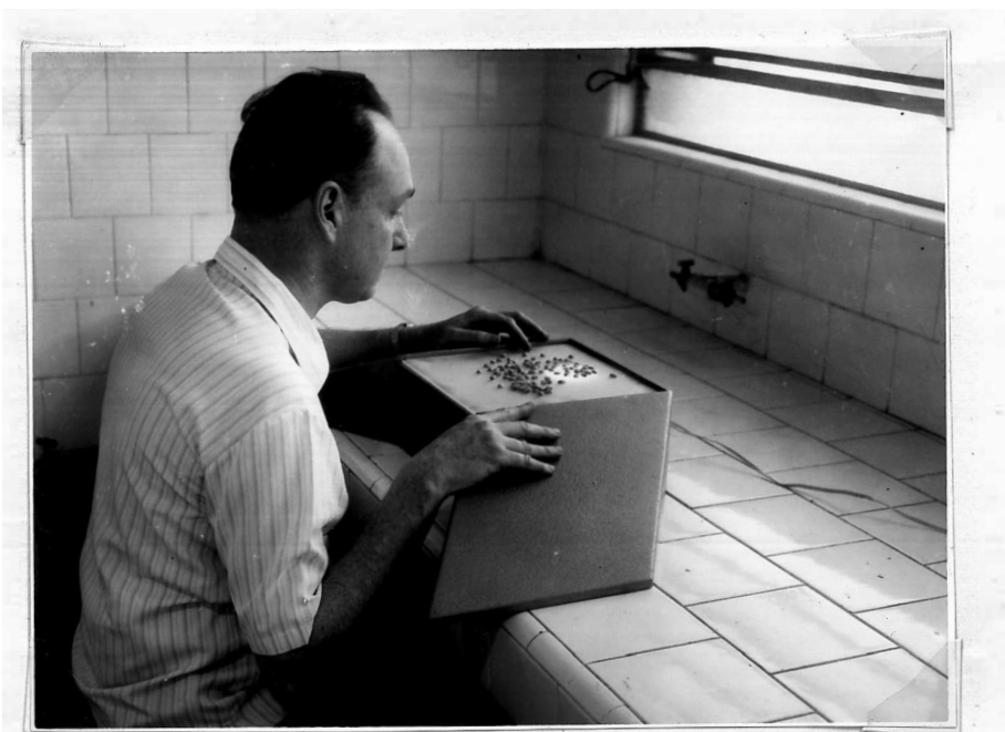
Fig.7 - Determinação de grãos perfurados no diafanoscópio.
