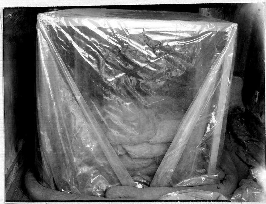
Fig.10 - Câmara de fumigação durante o expurgo.
