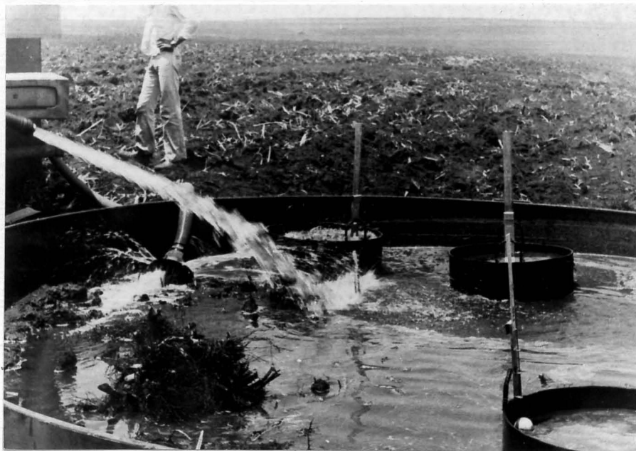
FIGURA 3 - Saturação do solo e instalação dos equipamentos.
