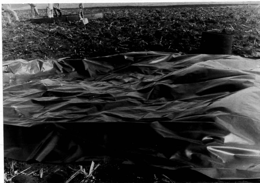
FIGURA 6 - Parcela saturada coberta com plãstico, para estudo de armazenamento e redistribuiçãõ da água no perfil.
