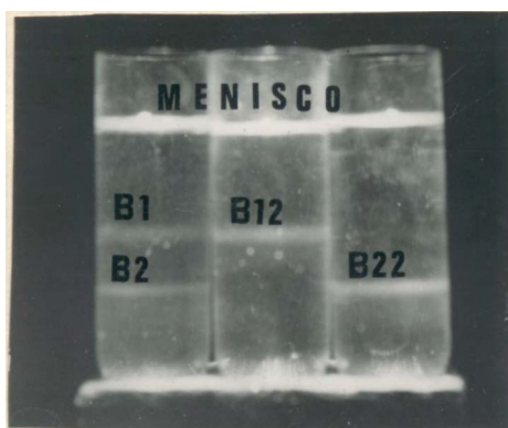
Figura 2. Tubos de gradiente de densidade. B-1 e B-2 (após o 1º gradiente); B-12 e B-22 (após o 2º gradiente).
