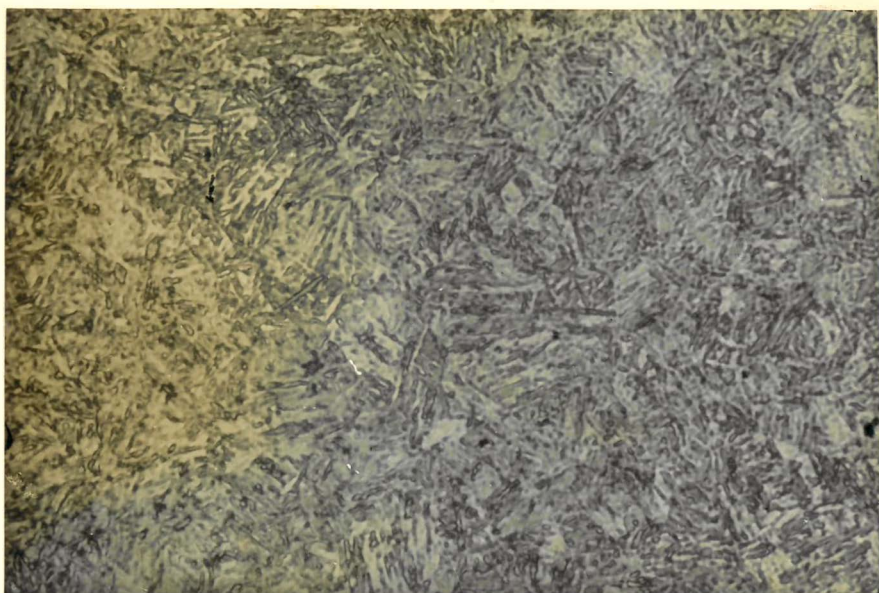
Figura 3. Aspecto da microestrutura do material II. Aço ABNT 1041 Classe A. Martensita revenida. Estrutura de aço temperado e revenido. Ataque Nital. Aumento 651 X. Ampliação 2 X.
