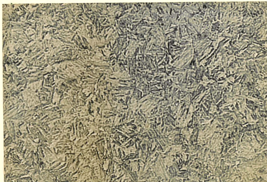
Figura 4. Aspecto da microestrutura do material III. Aço ABNT D 5119. Martensita revenida. Estrutura de aço temperado e revenido. Ataque Nital. Aumento 200 X. Ampliação 5 X.
