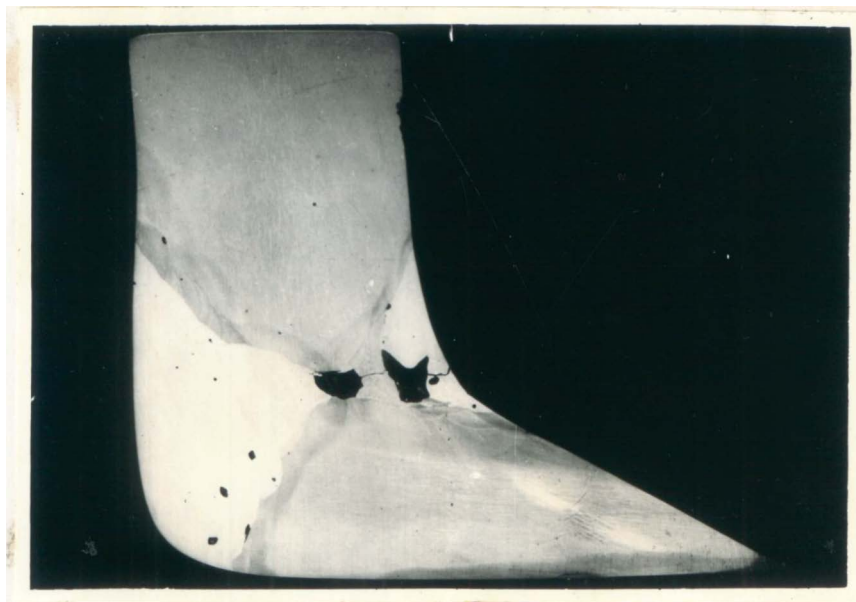
Figura 5.7.- Defeitos da solda - ocos
