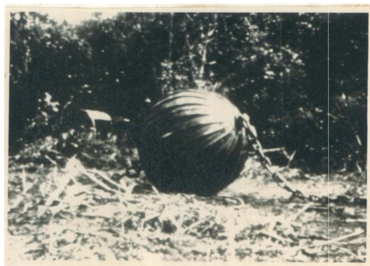
Figura 3.2.- Esfera de correntão para tratores Caterpillar D9C.
