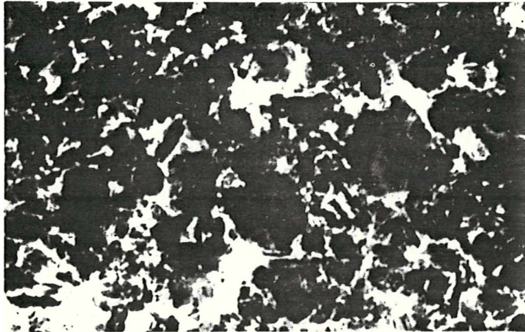
Fig. 14 - Micrografia eletrônica da argila da amostra B22 do perfil Q-4. Aumento: 46.560 X
