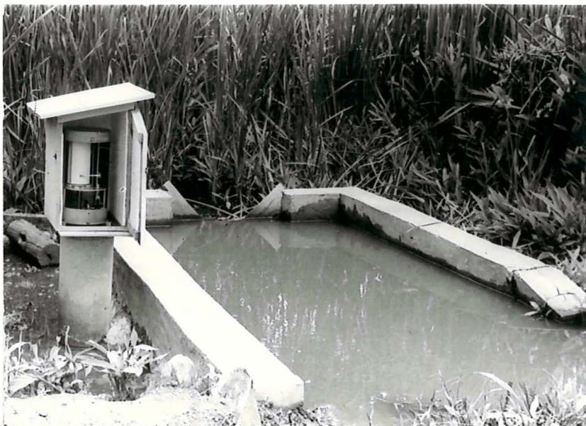
Fig. 8. Detalhes do vertedor de seção triangular e linígrafo utilizados na Bacia Hidrográfica do Paraíso.
