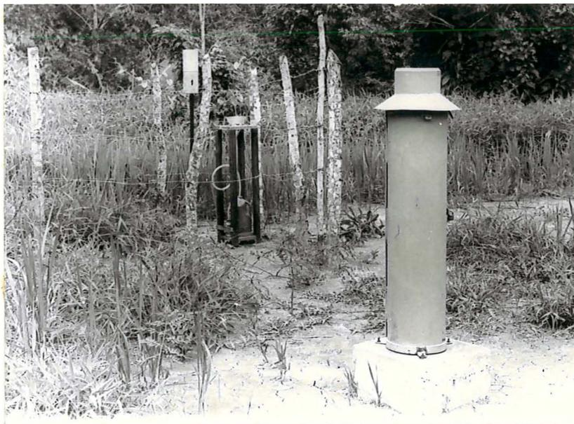
Fig. 7. Aspectos do pluviógrafo, coletor de amostras para análise qualitativa da água de chuva e pluviômetro, utilizados nas bacias experimentais.
