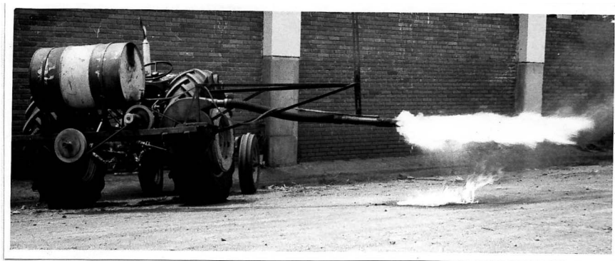
Figura 5 - Cultivador de chama em funcionamento
