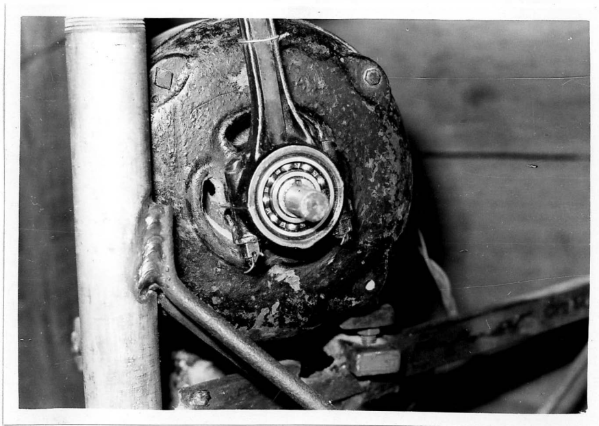
FOTOGRAFIA 17. - Destaque do excêntrico do vibrador, localizado dentro do rolamento de esferas.
