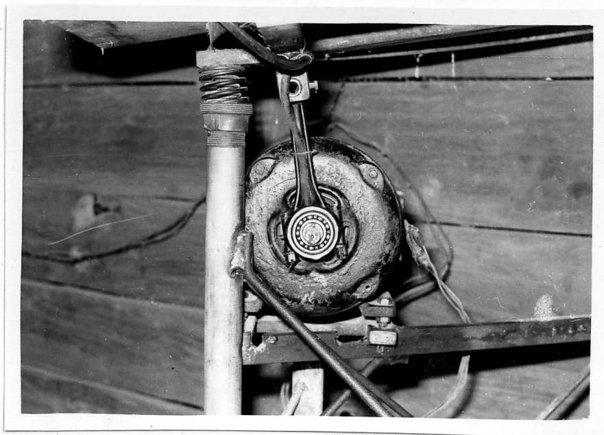
FOTOGRAFIA 16. - Sistema vibratório do alimentador, indicando o motor, biela e amortecedor.
