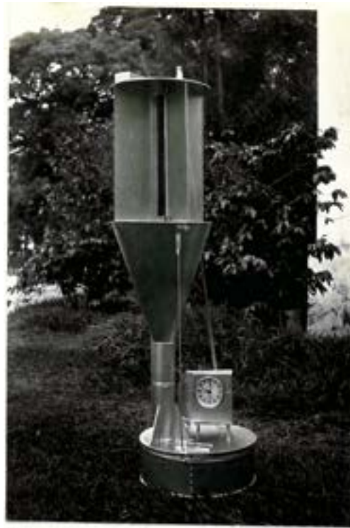
Fig. 6. Armadilha luminosa automática adaptada para determinação de hora de vôo de insetos.
