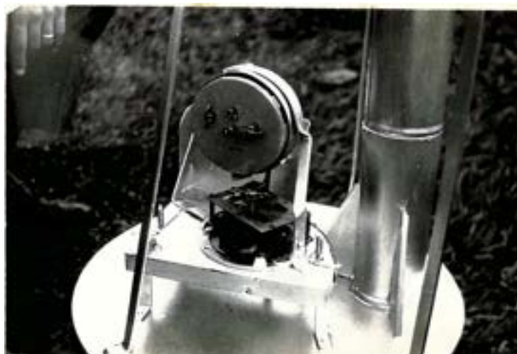
Fig. 9. Mecanismo responsável pela automati z ação da armadilha luminosa.
