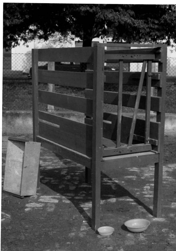
Fig. 1 - Gaiola de metabolismo com coletor de fezes.
