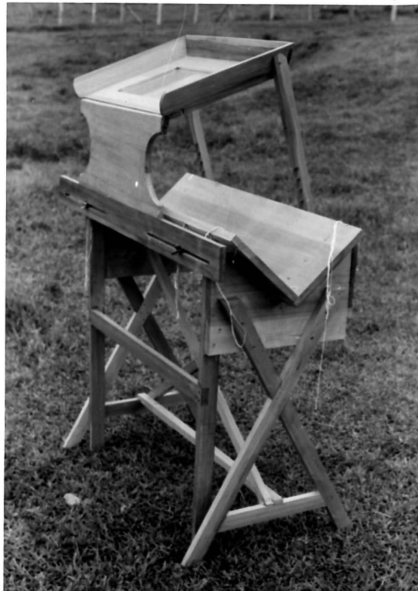
Fig. 5 - Mesa para contenção e necrópsia com protetor contra radiações
