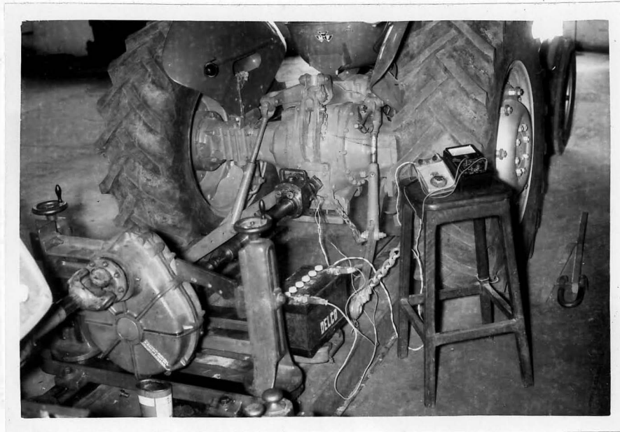
Figura 4.8. Torciômetro acoplado entre a TDP do trator e a caixa de multiplicação de velocidades, bateria e Multímetros utilizados nos ensaios de aferição em funcionamento.
