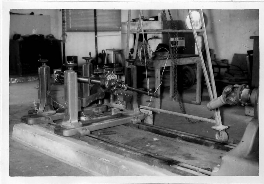
Figura 4.7. Detalhes do sistema utilizado para nivelar a barra de calibração e da montagem nas quatro colunas do banco dinamométrico.
