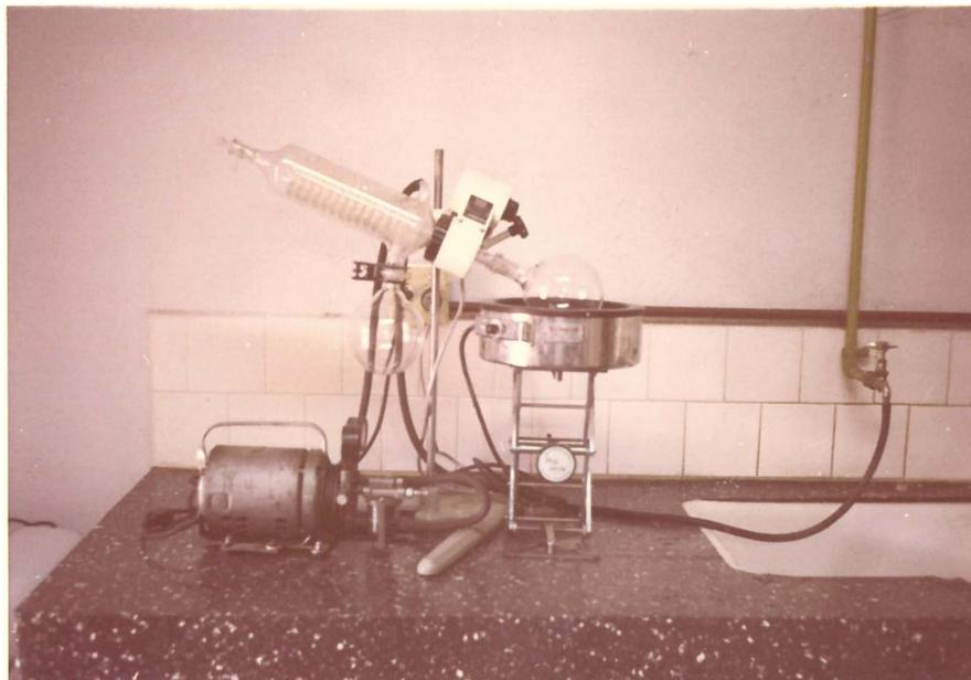
**Fig.2 - Evaporador rotativo Büchi**
