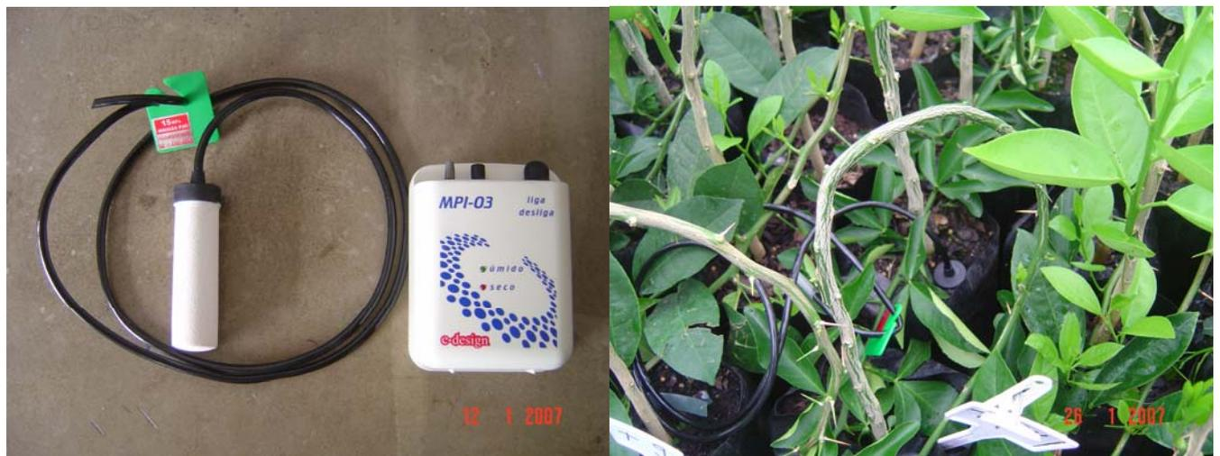
Figura 2 – Sensor Irrigás<sup>®</sup> empregado para monitoramento de potencial hídrico do substrato por tensiometria (esquerda). Instalação do sensor em sacola de muda cítrica (direita). Araras, 2007
