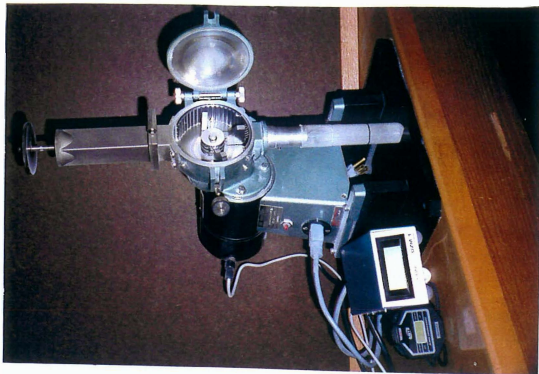
Anexo 15. Moinho de martelos modelo "Stenvert Test" e acessórios utilizados para avaliar a dureza dos grãos através de moagem.
