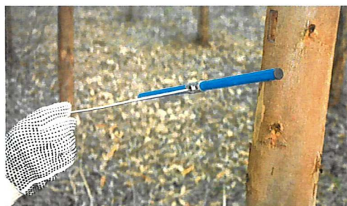
Figura 3 - Coleta de baguetas de madeira com um trado para análises físico químicas da madeira
