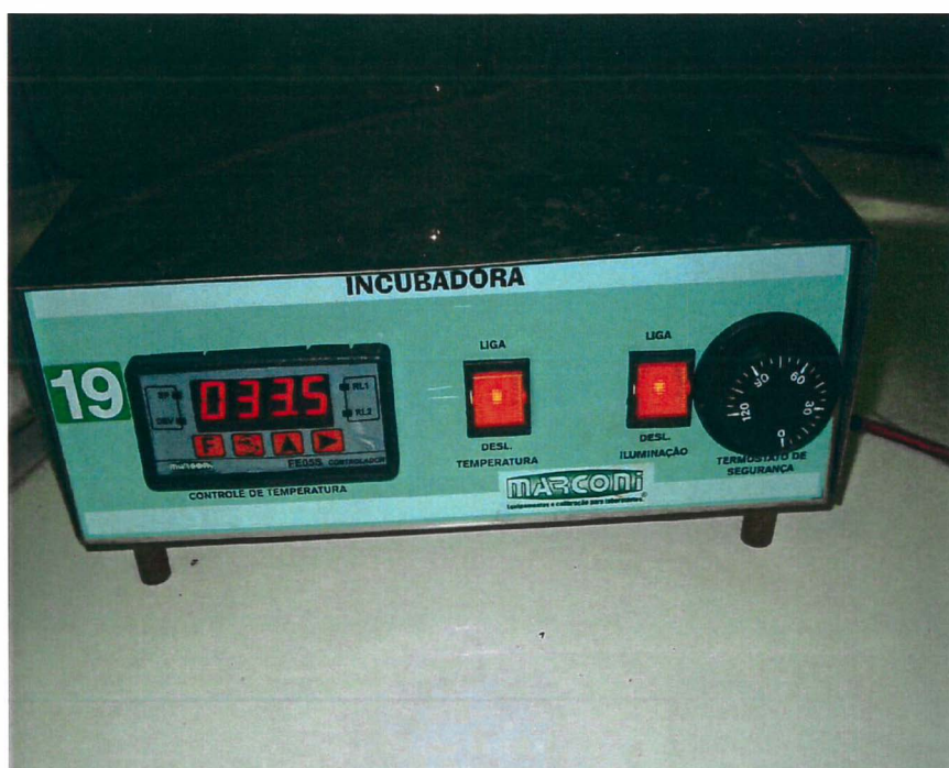
Figura 7 - Sistema eletrônico de reostato termopar das caixas aquecidas
