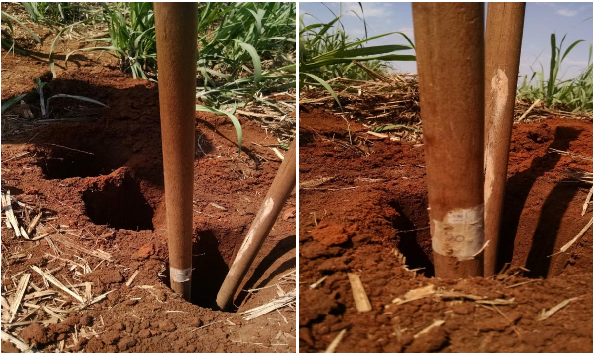
Figura 5. Métodos de amostragem através da escavação do perfil do solo com a utilização de cavadores manuais.
