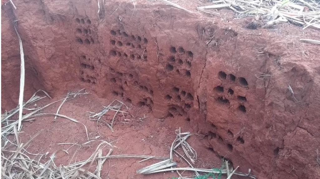
**Figura 14.** Exemplo de perfil após a retirada dos anéis volumétricos para determinação da densidade do solo.
