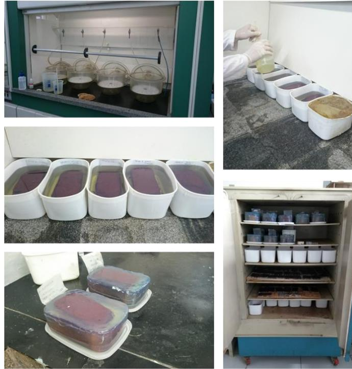
**Figura 9.** Processo de impregnação e secagem das amostras indeformadas.
