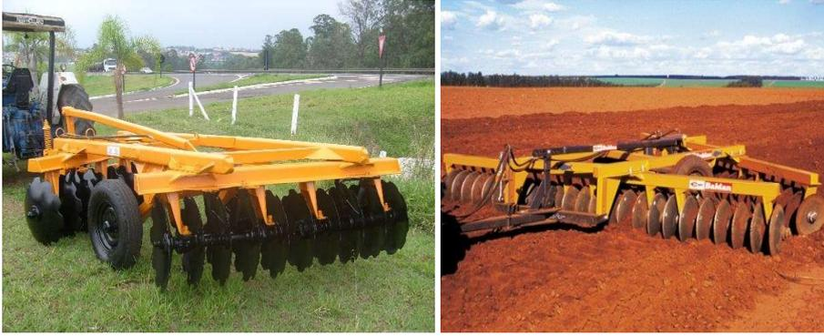
Figura 5. Implementos utilizados para o preparo convencional do solo.
