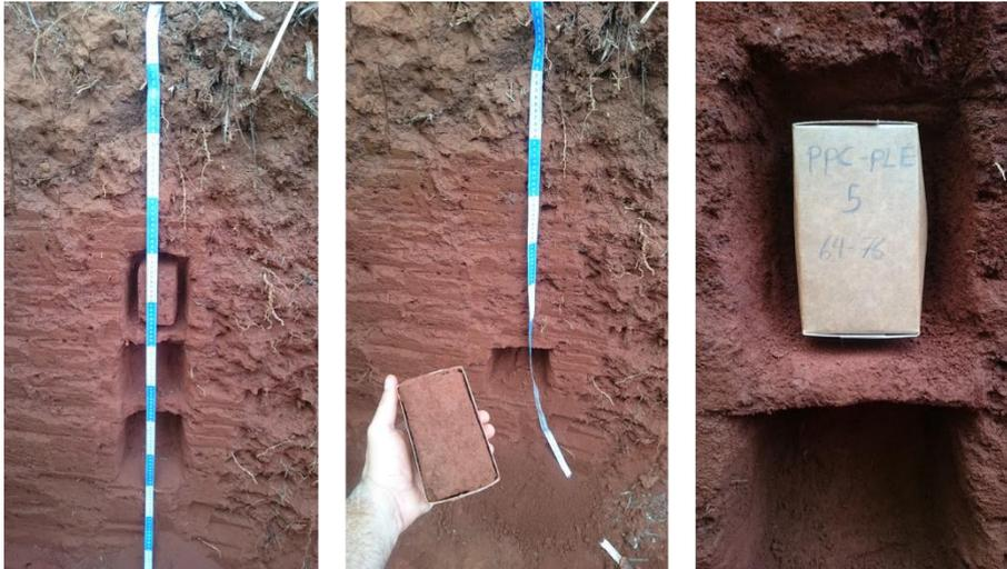
**Figura 8.** Exemplo da retirada de amostra indeformadas para análises micromorfométricas.
