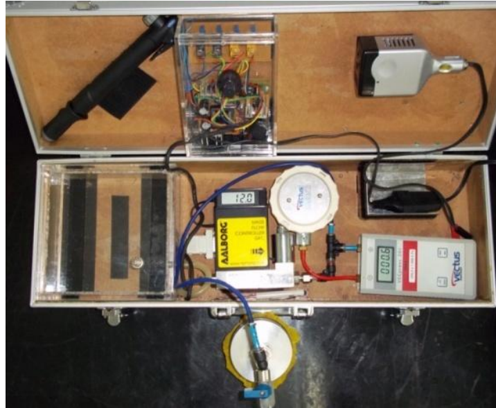
Figura 2 - Permeômetro de carga constante de ar (Figueiredo, 2010)
