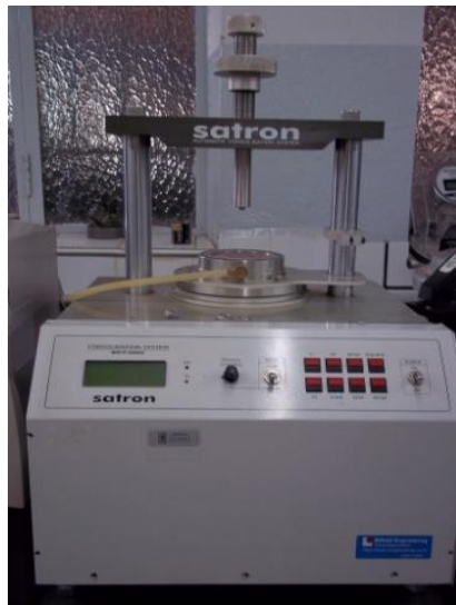
Figura 3 - Sistema de consolidação e aquisição de dados Satron MCT 2000
