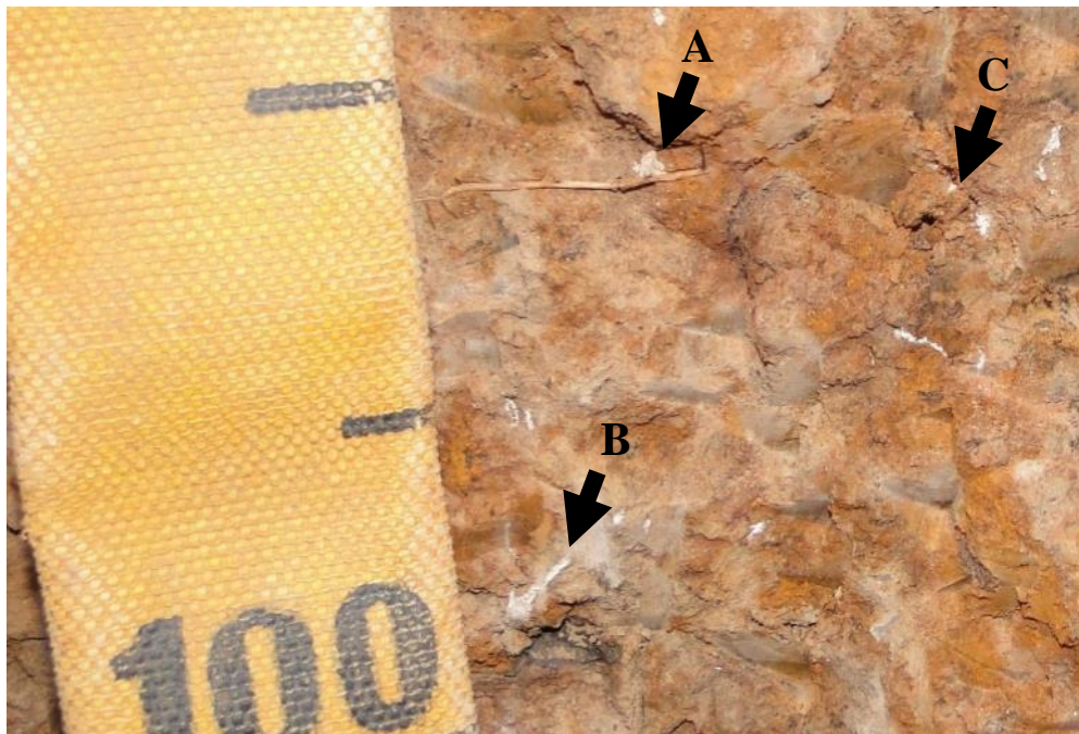
Figura 35 - Precipitações de \text{CaCO}_3 no horizonte Btnk do Setor 3. Ocorrência principalmente a canais de raízes atuais (A) e antigos (B) e fendas entre agregados (C)
