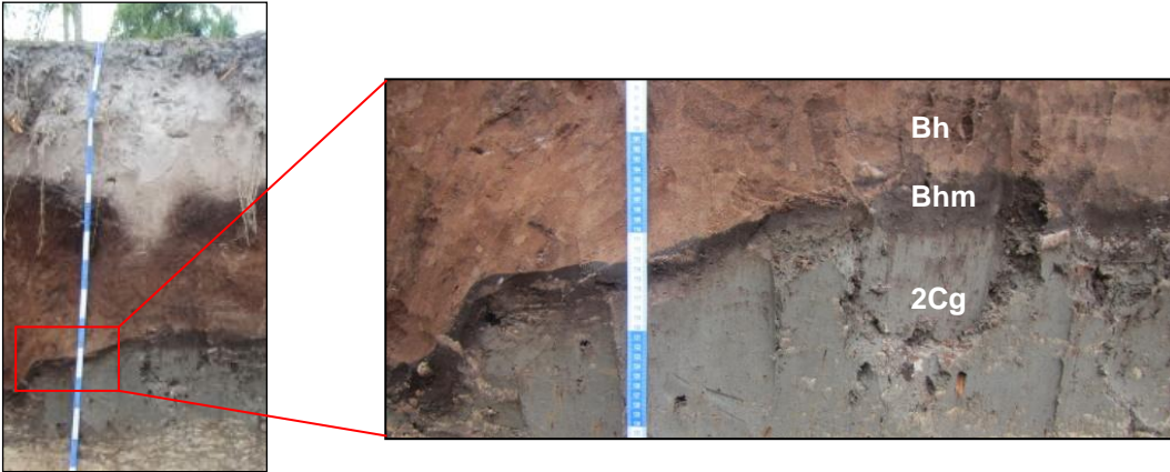
Figura 4.5 – Contraste entre os horizontes 2Cg (muito argiloso) e Bhm (arenoso), do perfil Caju4. A limitação da drenagem devida ao contraste textural força a deposição de MOD, gerando ou mantendo aí um estreito horizonte Bhm no perfil
