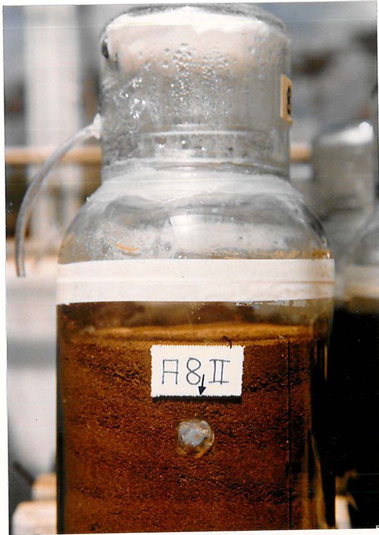
Figura 5. Coletor montado sobre vaso com solo. A seta indica o orifício para injeção de aquamônia a 5 cm de profundidade.
