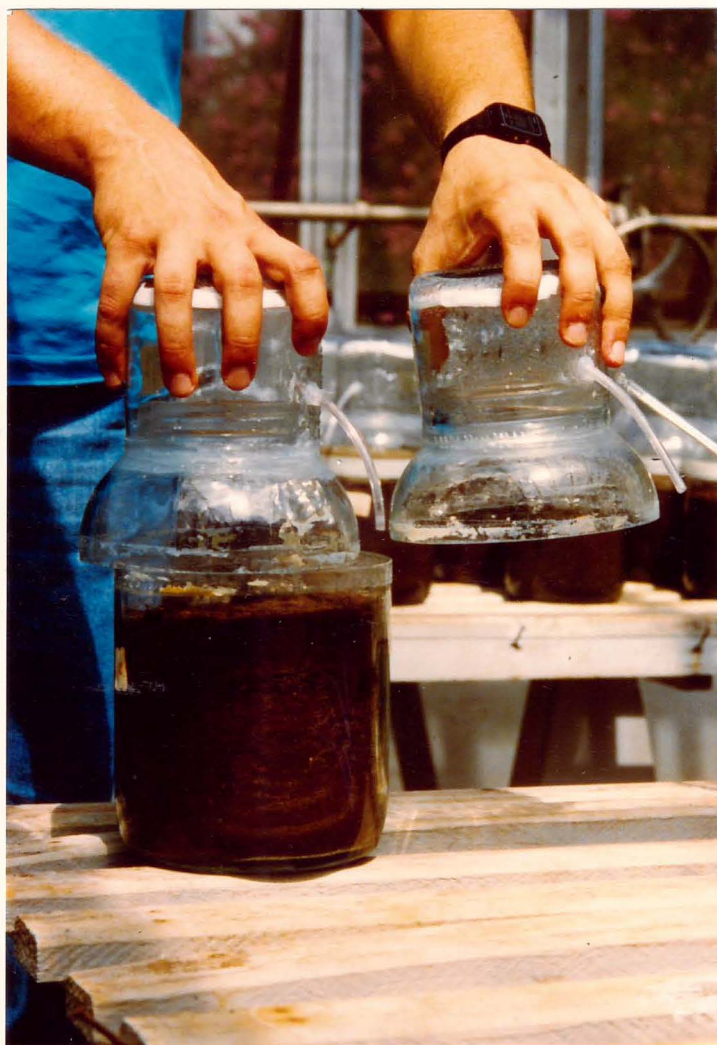
Figura 3. Coletor de amônia sendo acoplado a um vaso contendo solo.
