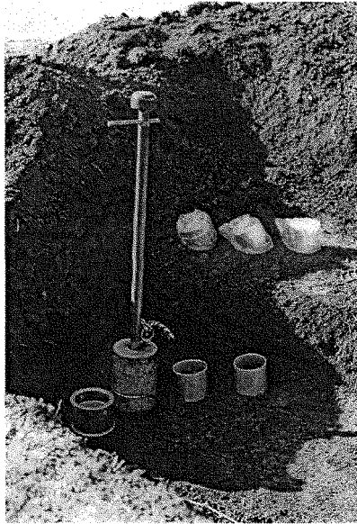
Figura 21 - Amostrador do tipo Uhland utilizado para a coleta das amostras indeformadas
