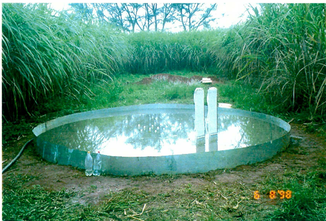
Figura 3. Área coberta após a inundação com o objetivo de saturar o perfil de solo até um metro de profundidade e logo protegida com plástico de polietileno preto para evitar evaporação e entradas de água.
