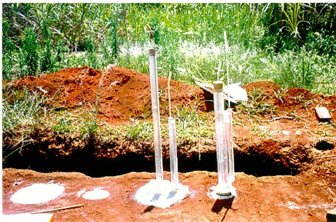
Figura 6. Área preparada para um ensaio e o infiltrômetros em funcionamento no processo de medição.
