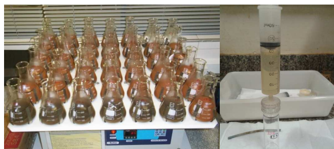
Figura 6. Etapas da extração de carbono orgânico dissolvido. Da esquerda para direita: agitação de solo + biocarvão com água ultrapura; filtragem do sobrenadante em membrana de fibra de vidro.
