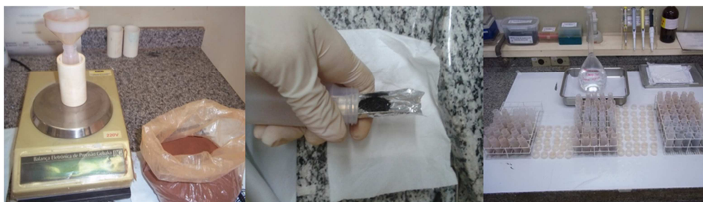
Figura 3. Etapas do experimento de sorção. Da esquerda para direita: pesagem do solo em tubos de teflon, adição de biocarvão e adição de solução radiomarcada.
