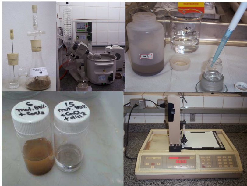
Figura 8. Etapas da condução do experimento de dissipação de ^{14}\text{C} -tebuthiuron e ^{14}\text{C} -hexazinona em solos de textura contrastante sob aplicação de biocarvão. Da esquerda para direita, de cima para baixo: detalhe do frasco de Bartha, com compartimento acessório para o armazenamento de NaOH; rotovapor; pipetagem do extrato para contagem no cintilador líquido; aparência do extrato após rotoevaporação e ressuspensão em metanol; aplicação do extrato concentrado na placa de TLC ( Thin Layer Chromatography ).
