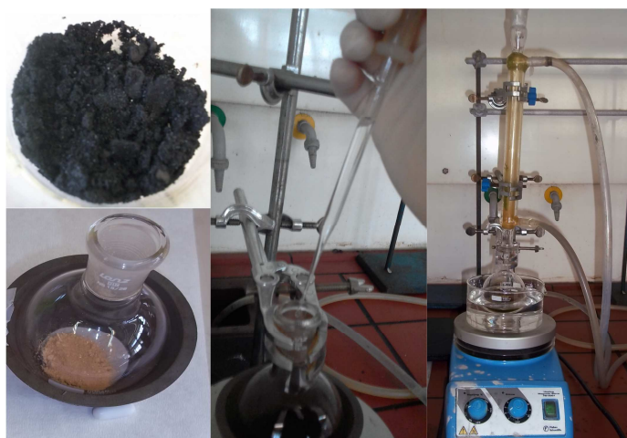
Figura 10. Etapas da síntese dos catalisadores heterogêneos Mn II -Lacac-PC550 ox e Mn II -Lacac-SE550 ox : de cima para baixo e da esquerda para direita: biocarvões após oxidação com HNO 3 , síntese do precursor Lacac-Mn II -silano, adição de MnCl 2 ·4H 2 O e sistema de refluxo utilizado em todas as etapas.
