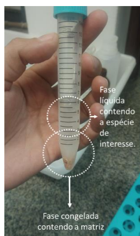
Figura 17. Foto da SLE-LTP na extração do propoxur da carne bovina, após parâmetros otimizados
