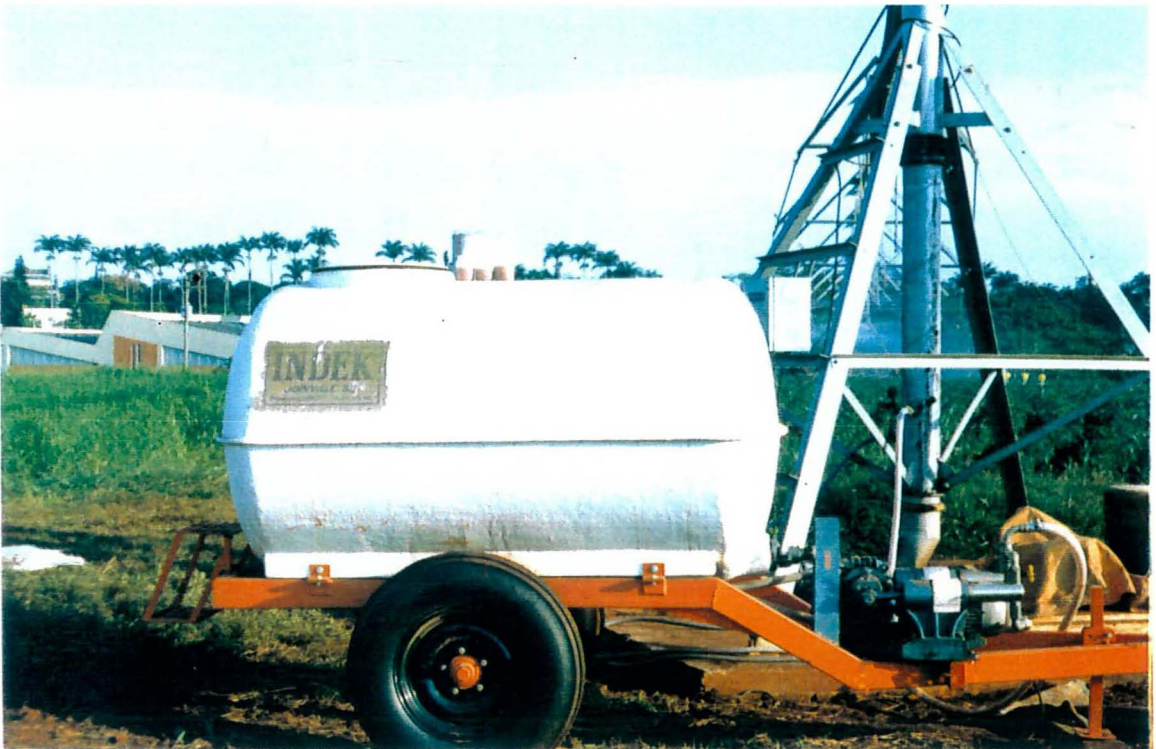
Figura 8 – Tanque e bomba injetora de fertilizantes instalados no centro do pivô.
