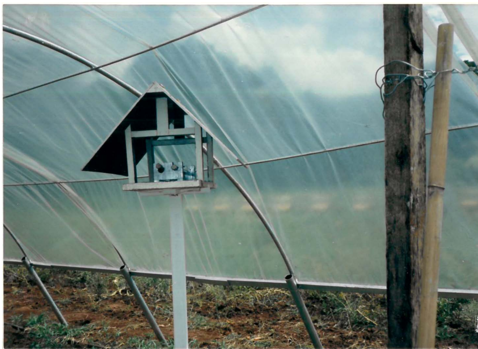
FIGURA 2. Abrigo padrão com termômetro de máxima e de mínima.
