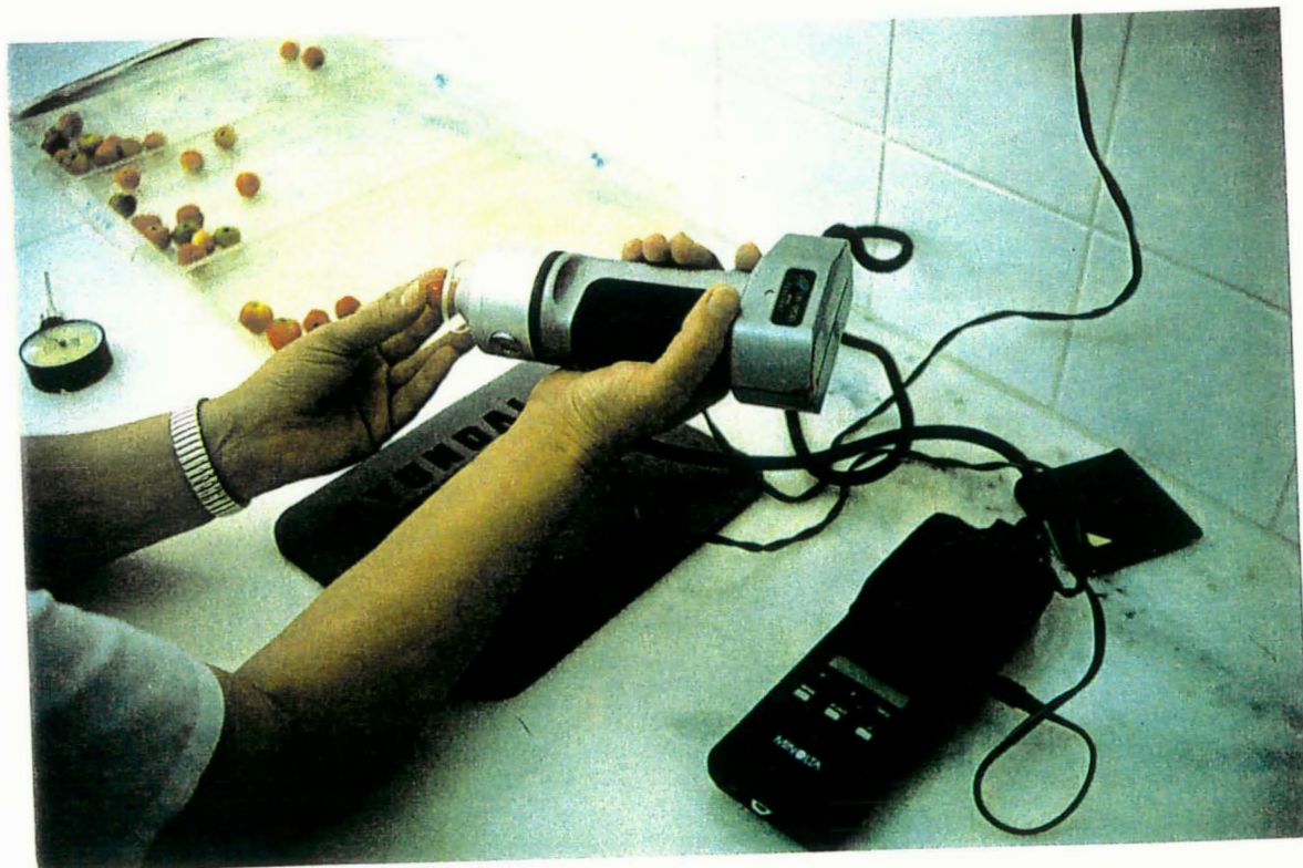
Figura 5 Medição da coloração do fruto (índices “L”, “a”, “b”), com o uso de colorímetro Minolta CR-200.
