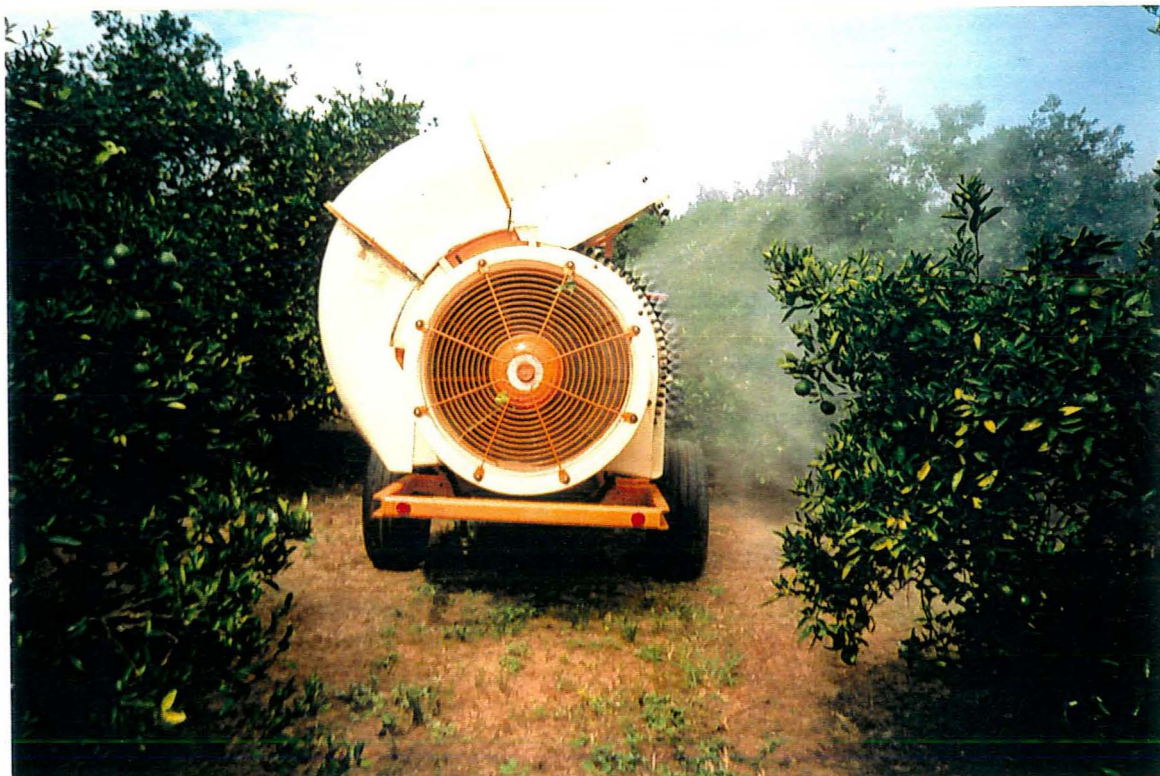
Figura 3. Pulverização do traçador fluorescente no pomar com o turboatomizador Arbus 2000 / Export.
