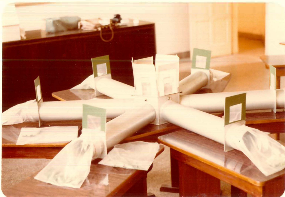
Figura 2 - Testador de luz adaptado para o teste de atratividade de hortaliças.
