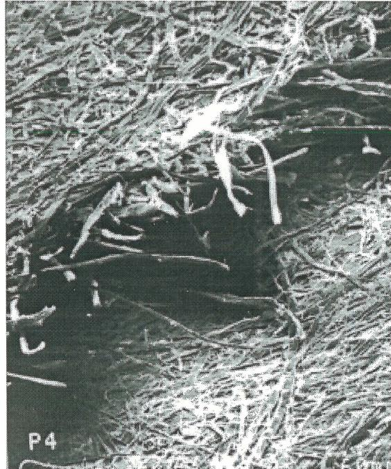
Figura 5.13 Micrografia de uma folha feita com a mistura de 30% de pasta termoquímica à soda e 70% de pasta capa A ( 100 x)
