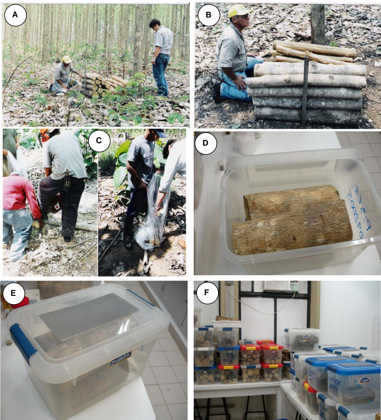
Figura 2 – (A) Pilha de madeira de Tectona grandis com casca e sem casca dentro do talhão; (B) Pilha de madeira selecionada para a retirada das amostras com casca e sem casca; (C) Secção dos torretes e acondicionamento em sacos plásticos; (D) e (E) Caixas plásticas de 445 mm x 275 mm x 323 mm com tampa perfurada utilizadas para acompanhar a emergência de insetos adultos; (F) Acomodação e armazenamento do material durante 4 meses em laboratório
