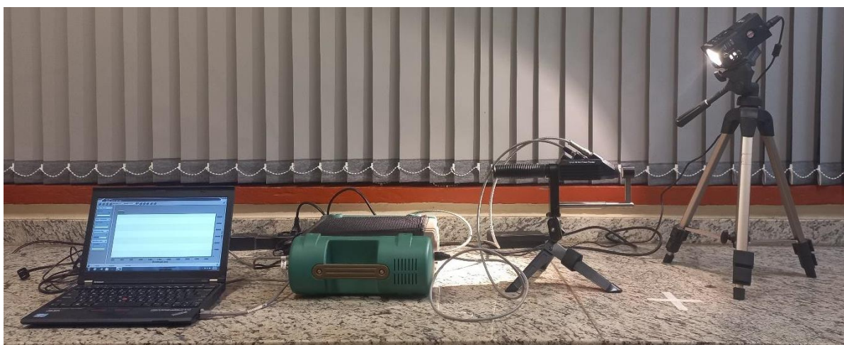
Figura 9. Representação esquemática do espectrômetro ASD Inc. Fieldspec 4 WIDE – RES/ Unit 18153 Plant Probe .
