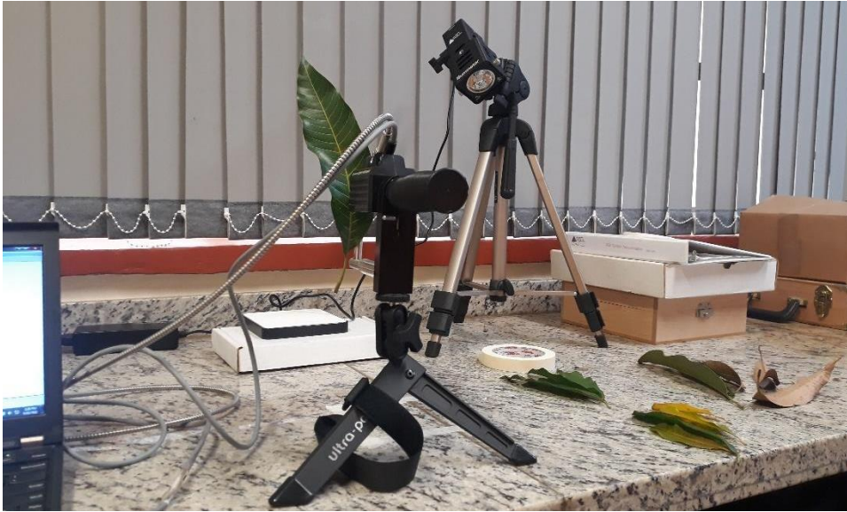
Figura 7. Representação de coleta de dados espectrais utilizando espectrômetro ASD Inc. Fieldspec 4.
