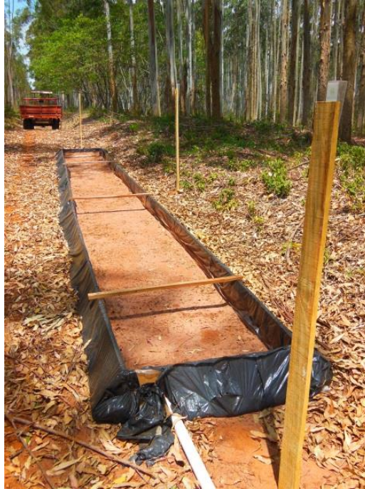
Figura 3.5 – Parcela com 3 pluviômetros tipo cunha instalados
