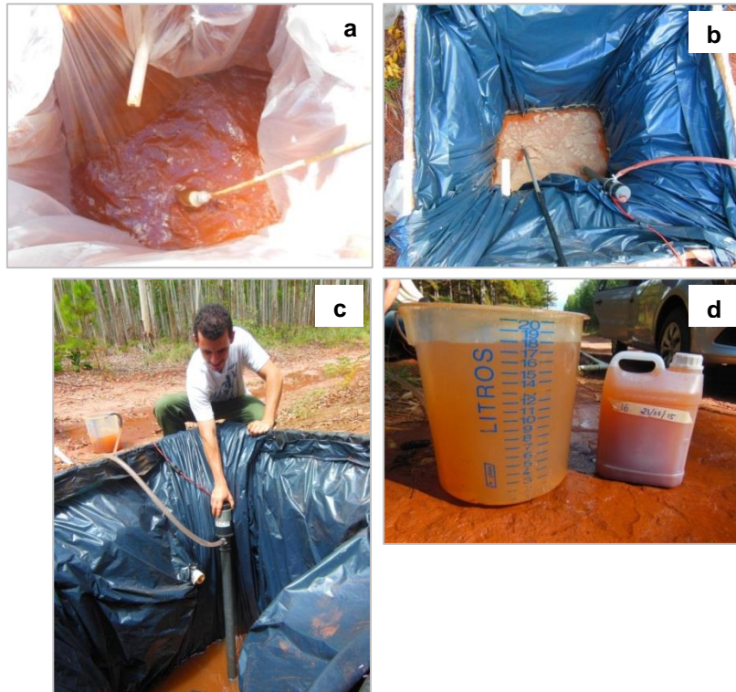
Figura 3.4 - Etapas da coleta: homogeneização do volume total armazenado (a); bombeamento da água homogeneizada (b); sucção do volume de água por meio de uma bomba d'água (c); e coleta da amostra para a determinação da concentração de sedimentos e medição total do volume armazenado (d)
