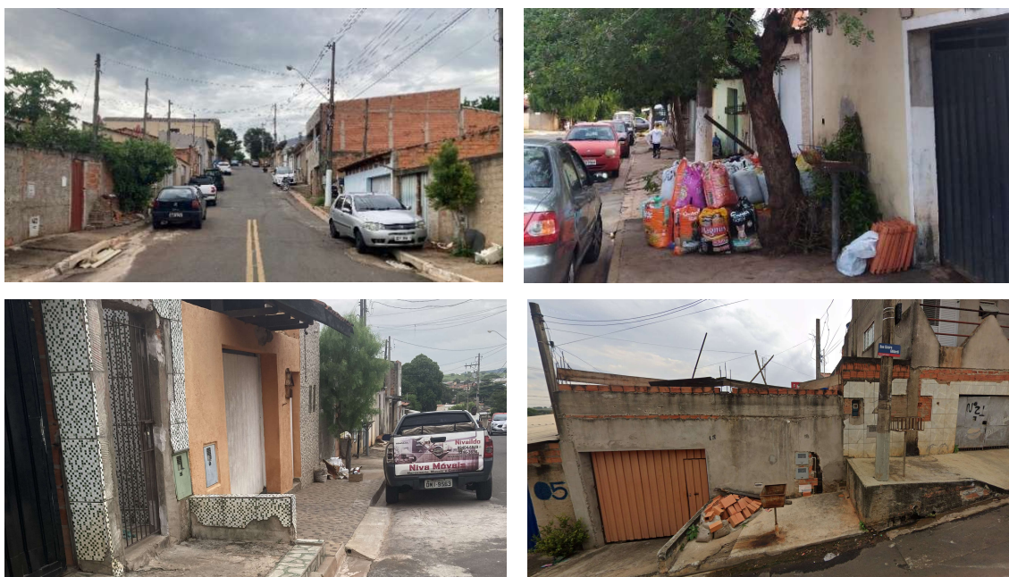
Figura 39. a) e b) Imagens de barreiras em calçadas por uso indevido, como: ocupação para depósito de materiais diversos, carros estacionados, espécies de árvores pequenas e arbustivas e, carros estacionados sobre as calçadas. c) e d) Imagens mostrando barreiras construtivas como mureta, degraus e desníveis. Fonte: a autora.
