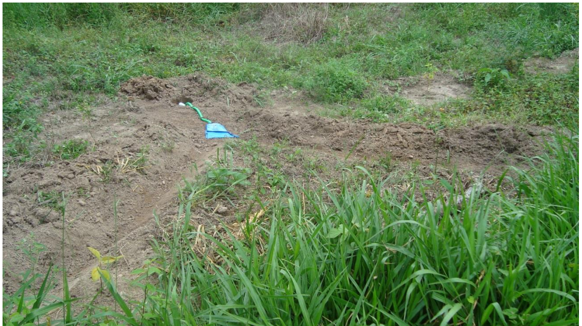
Figura 4 – Coletores instalados na extremidade inferior das parcelas utilizadas para avaliação do experimento; os canais abertos objetivaram direcionar a água de enxurrada para captação
